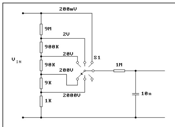
Figure 2. Multirange Voltmeter
